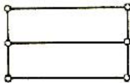
图 B.0.2 建筑物易受雷击的部位（二）
