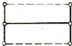
图 B.0.3 建筑物易受雷击的部位（三）
